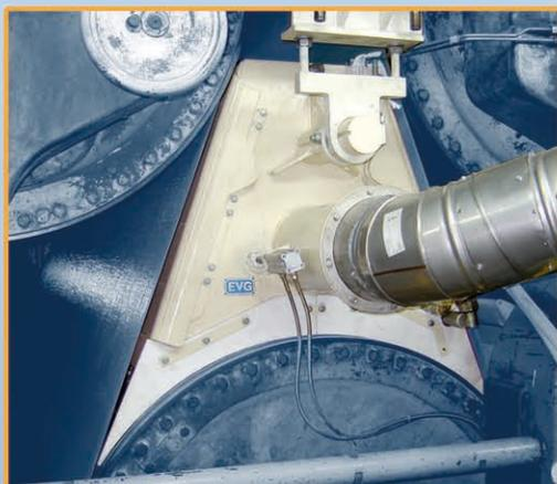
Beim EV EasyGo Konzept wird der Stabilisator über der Saugwalze montiert und stützt den Lauf der Bahn durch Erzeugung von Unterdruck innerhalb der Saugwalze. Die EV EasyGo -Einheit saugt Luft über die Löcher der Saugwalze ein und bläst gleichzeitig Luft aus den Düsen des Stabilisators. So wird Unterdruck zwischen dem sich öffnenden Zwickel bis zum sich schließenden Zwickel hergestellt.
