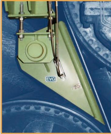
Der EVSf-Stabilisator bläst Luft in den Bereich zwischen Oberzylinder und Unterzylinder. Die Strömung der Blasluft erzeugt Unterdruck, der die Papierbahn über den gesamten Bereich effektiv am Sieb hält. Im oberen sich schließenden Zwickel entstehen keine Luftblasen oder Falten, da keine Luft zwischen Bahn und Sieb eingezogen wird. Ferner kann sich die Bahn nicht im Bereich des Unterzylinders dehnen oder durchhängen.
